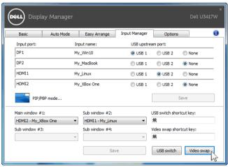
يمكنك تعيين منفذ USB للتدفق الأعلى مع إدخال الفيديو الخاص بك. سيتم توصيل منفذ USB للتدفق الأعلى المعين بالكمبيوتر في حالة عرض الفيديو الخاص به على الشاشة. و هو مفيد بشكل خصوصي عند مشاركة الماوس ولوحة المفاتيح المتصلة بالشاشة بين جهازين كمبيوتر. يمكنك تعريف مفتاح اختصار لسرعة تبديل الجهاز بين جهازي الكمبيوتر.
